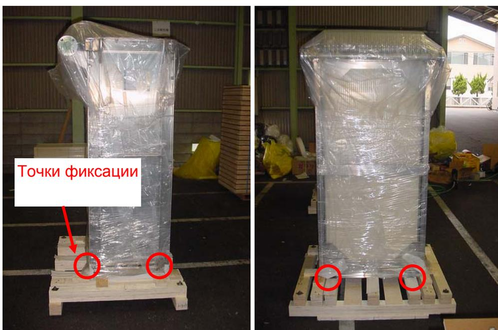
Блок мембранных элементов и аэрационный блок на паллете покрываются двухслойным картоном, который фиксируется к паллете в основании с помощью болтов-саморезов.
